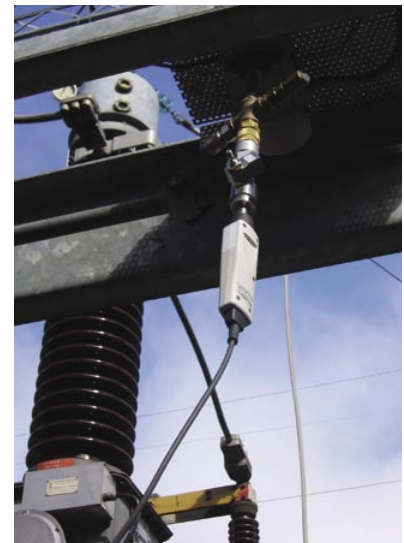
Vaisalan DM70-käsimittari on optimoitu SF6-kaasun kastepisteen mittaukseen.
